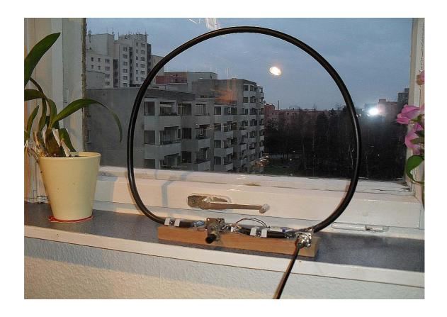
Die Loop besteht aus einem 5-aderigem Kabel was wie im Bild zusammengeschaltet wird. Man beginnt mit einer Farbe und verbindet auf der anderen Seite des Kabels, das Ende mit dem Anfang der nächsten Ader usw.
