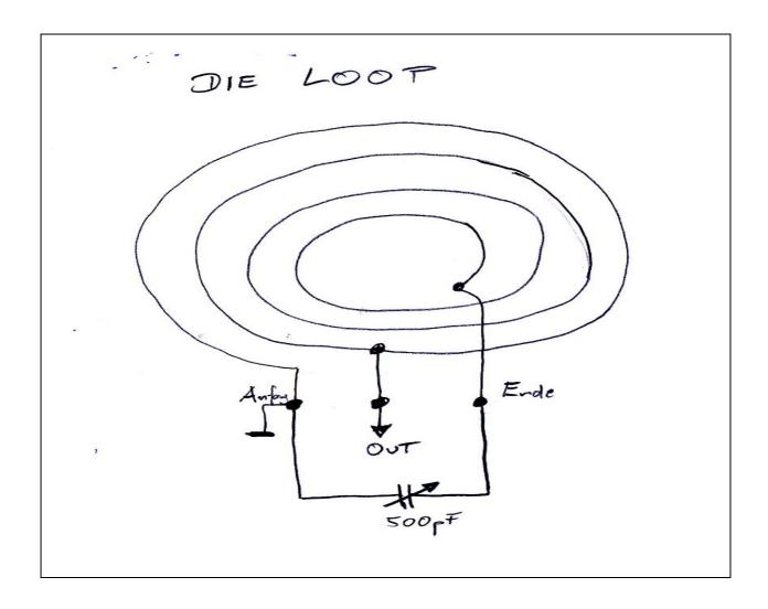
Man erkennt den Anfang und das Ende der Spule, sowie den Abgriff für den Ausgang der Antenne. Der Drehkondensator zur Abstimmung der Loop ist auch zu erkennen und liegt zwischen Anfang und Ende der Spule.
