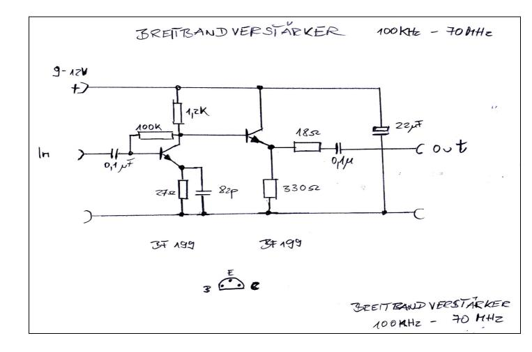
Dies ist der Breitbandverstärker mit einer Eingangsimpedanz von 300 Ohm und einer Verstärkung von ca. 20dB in der ersten Stufe.
